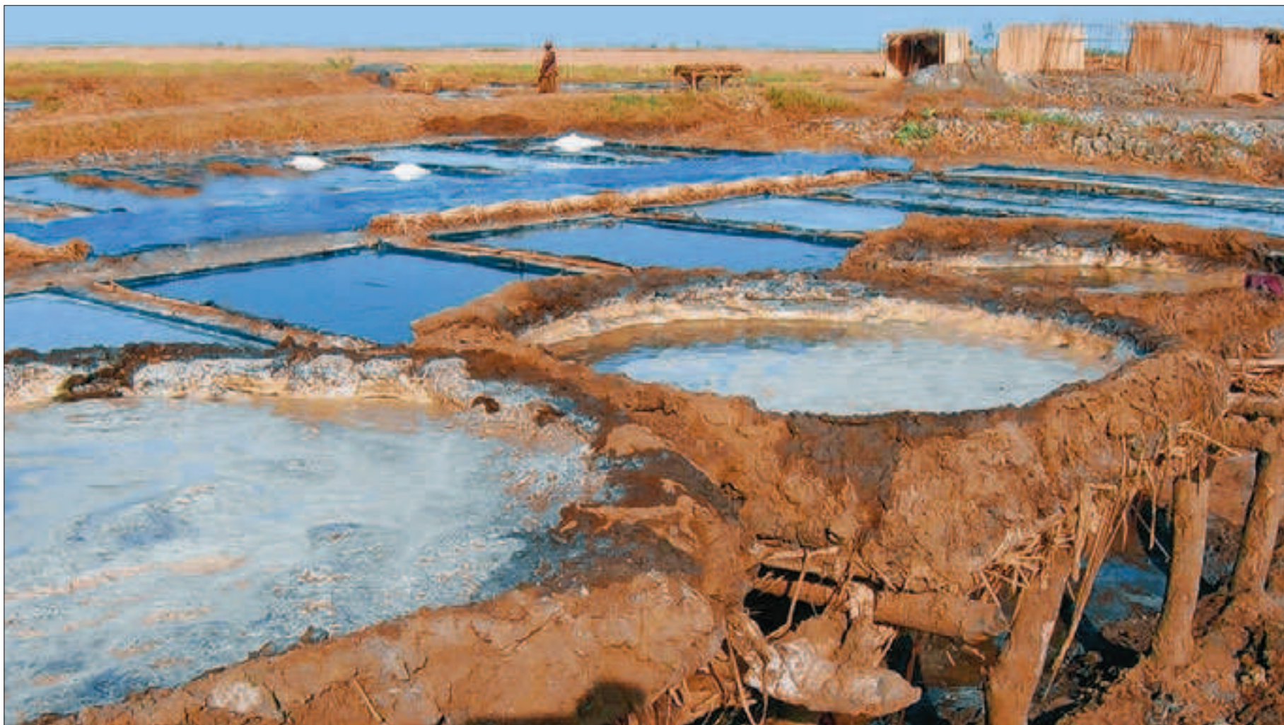
Le système de bassins recouverts d'une bâche pour obtenir du sel par évaporation a été mis en place par les producteurs guérandais. Depuis, leur appui technique est demandé un peu partout.
